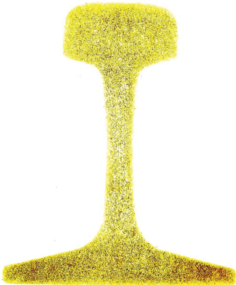
Рисунок И.1 — Макроструктура без ликвации (серный отпечаток)
