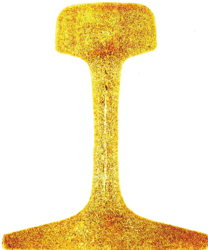
Рисунок И.3 — Обратная ликвация в шейке (серный отпечаток)
