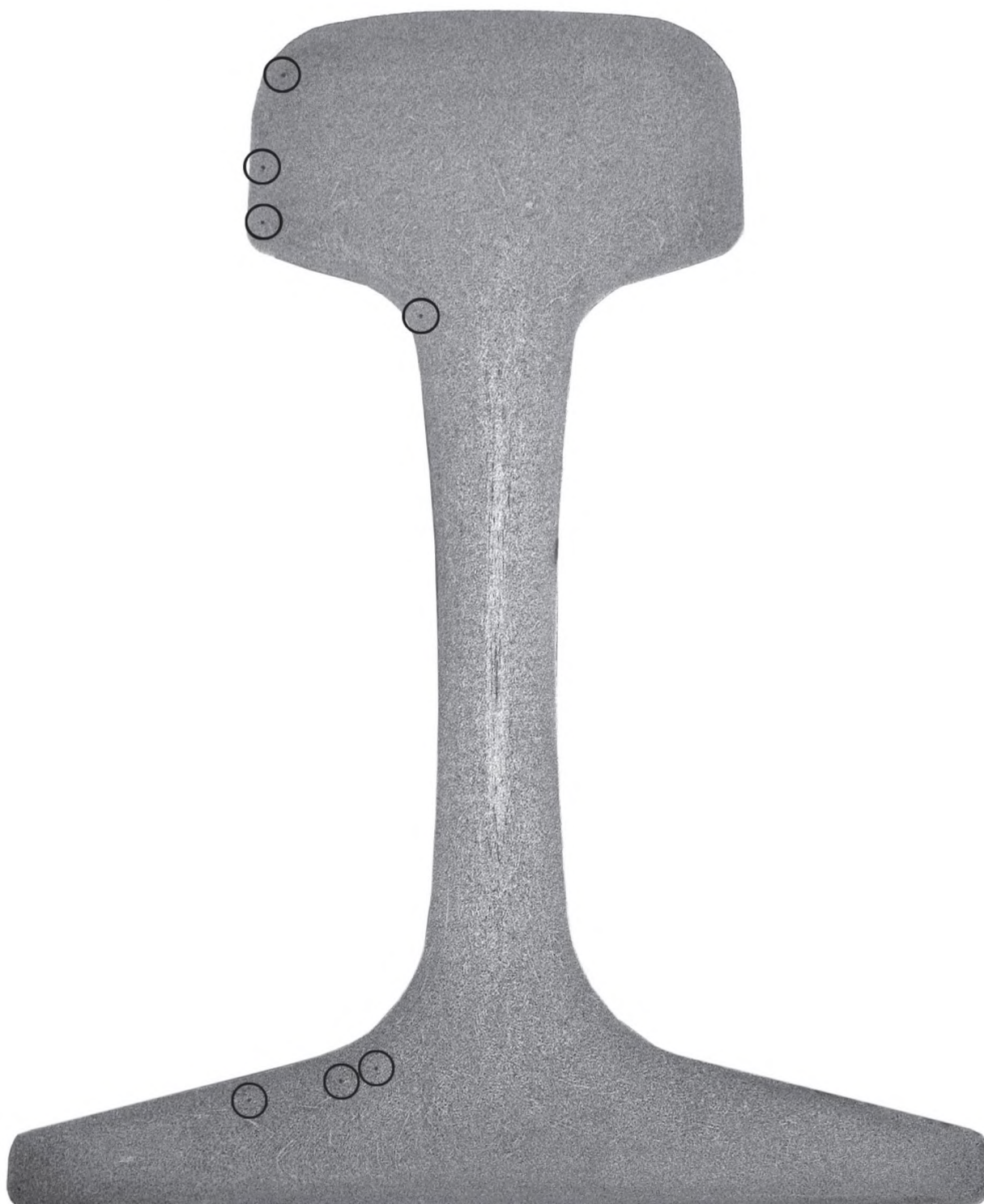
Рисунок И.11 — Наличие более 6 одиночных точек на поперечном сечении рельса (глубокое травление)
