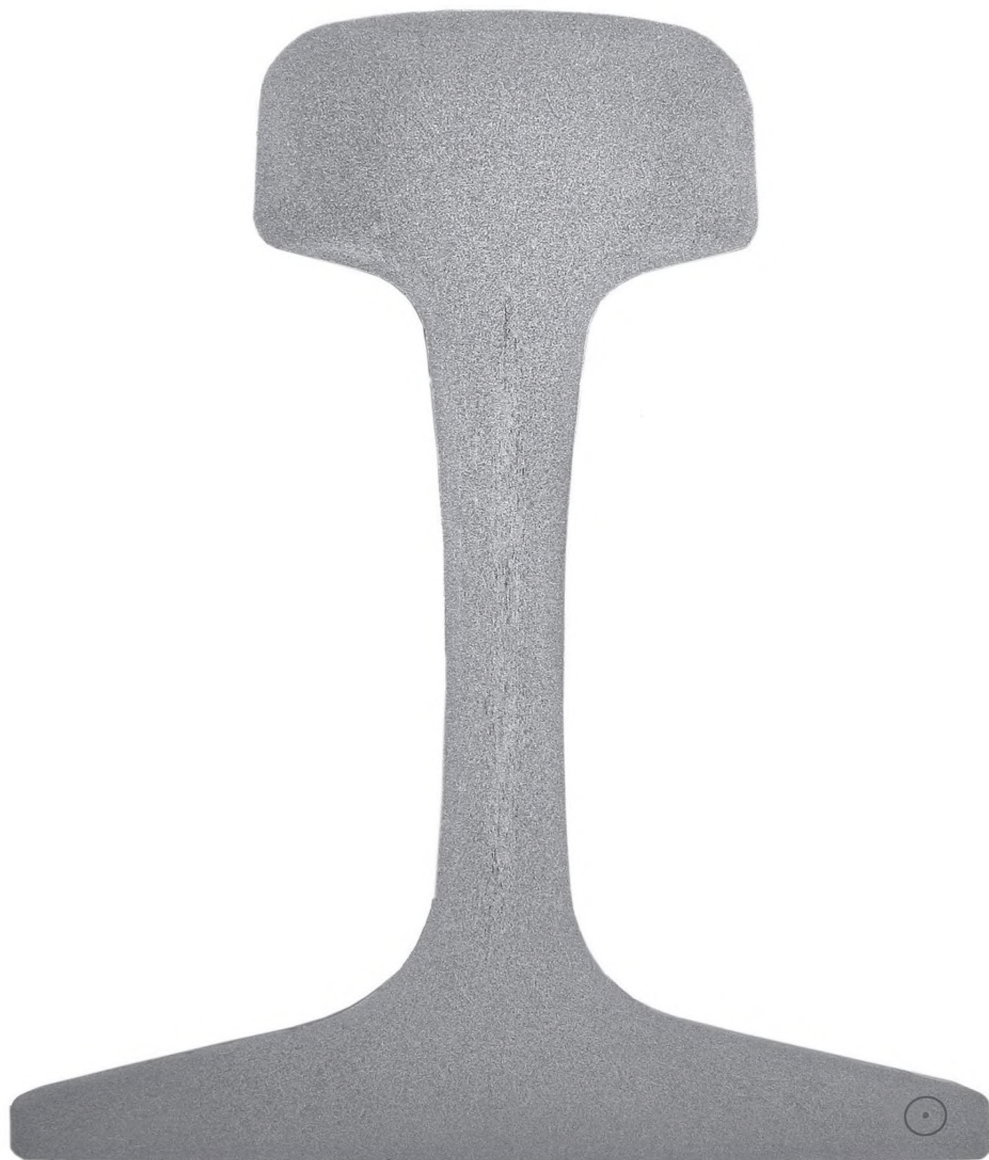
Рисунок И.9 — Одиночные точки диаметром более 1 мм (глубокое травление)
