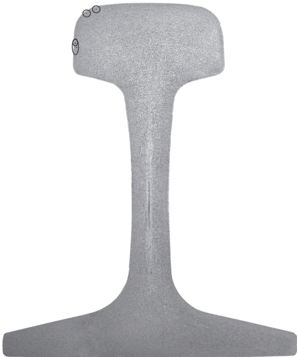
Рисунок И.10 — Наличие более 3 одиночных точек в одном элементе профиля (глубокое травление)
